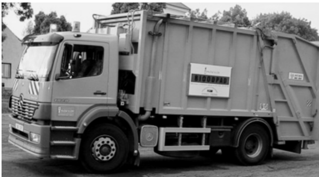
Svozové vozidlo na bioodpad
