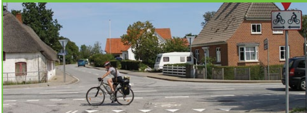
▲ Stezka podél hlavní komunikace se stejnými právy pro cyklistu jedoucího souběžně s ní
