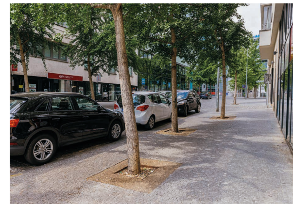
✘ Poněkud nelogicky rozmístěné stromy, navíc v rozměrově neodpovídajících rabatech s nevhodně materiálově řešenou obrubou z kortenu.
